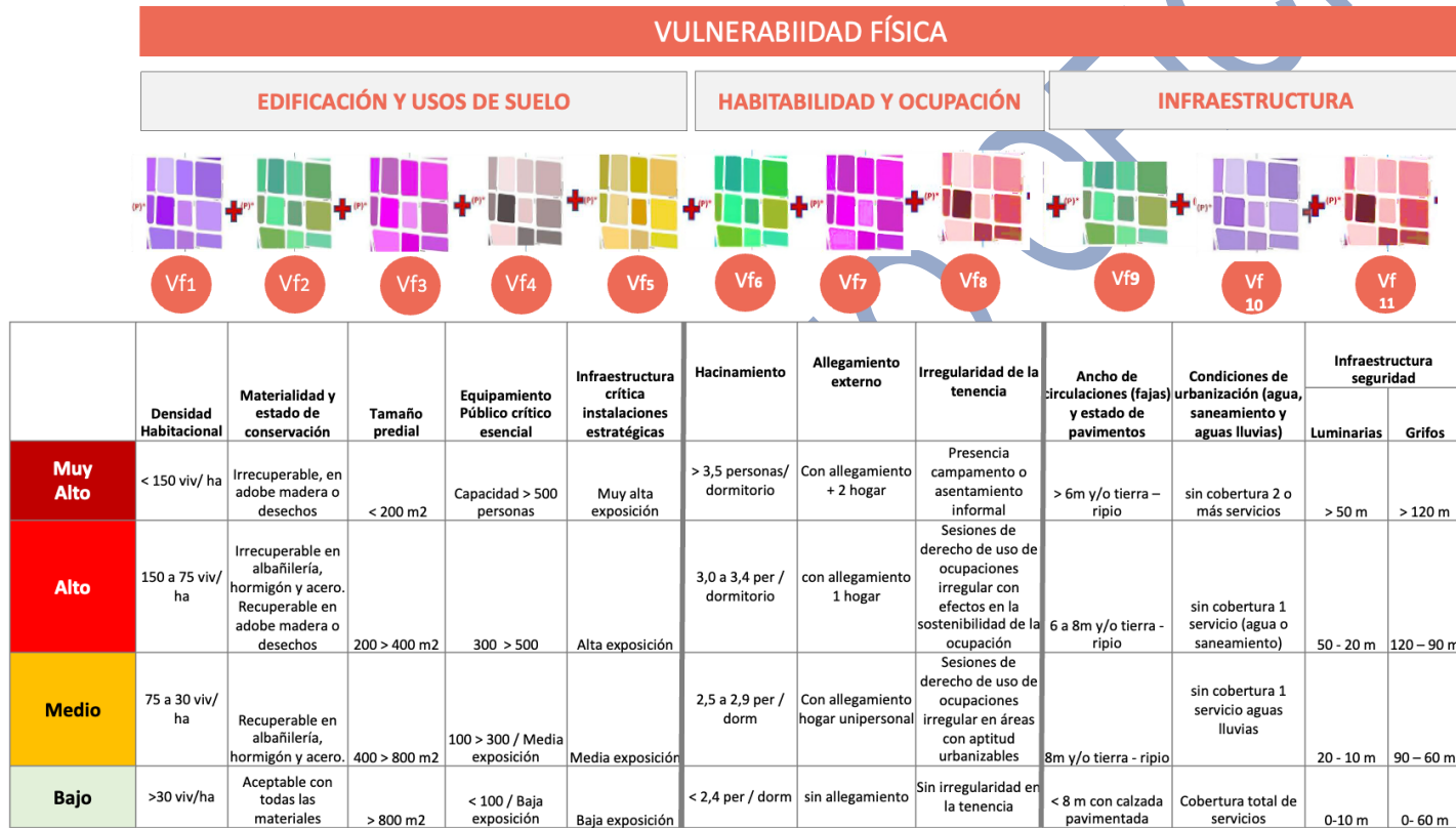
Ilustración 2-12: Factores - variables y categorías de valor para determinar los niveles de Vulnerabilidad Física
